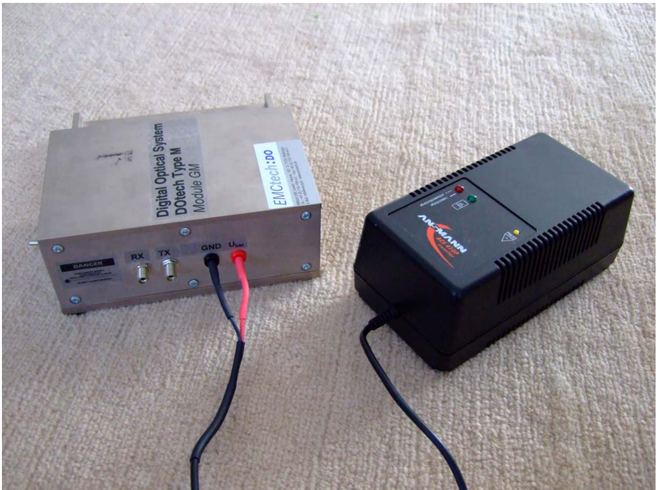
Bild 1: Anschluß des Ladegeräts an das ausgeschaltete Grundmodul
